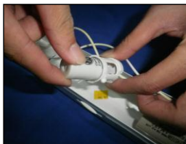
Langkah 3: Keluarkan "starter" daripada "starter holder" dan masukkan "starter
