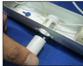
Langkah 4: Masukkan semula "starter" kedalam "starter holder" seperti yang ditunjukkan dalam gambarajah.
