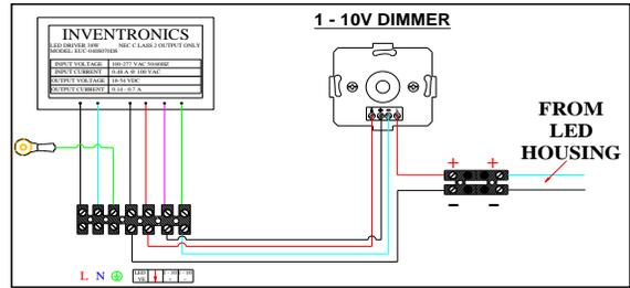
**Wiring Diagram For Dimmable Switch**
